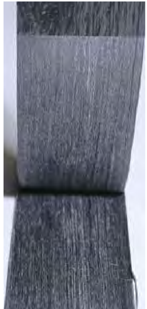
Bruchfläche zwischen dem getrennten Tape und dem Rest des Materials.
