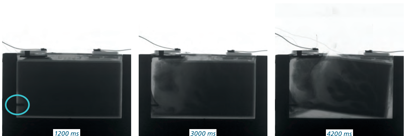
Videobilder der zellinternen Vorgänge nach dem Anstechen einer geladenen Zelle mit einem Nagel (blauer Kreis links unten im ersten Bild), aufgenommen mit 1000 Bildern pro Sekunde.
