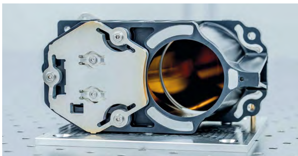
Die Optik des Messinstruments besteht aus speziell geformten Metallspiegeln, die auf Nanometer genau bearbeitet und mit einer Goldschicht überzogen wurden. © Fraunhofer IOF
