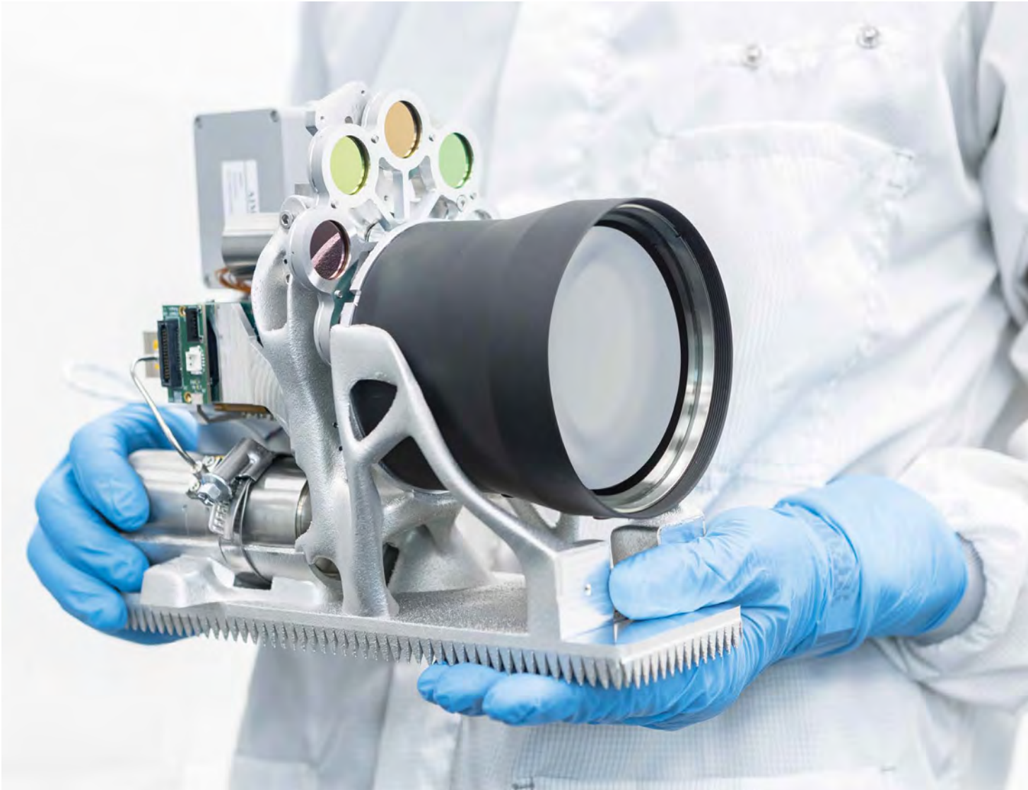
Integrierte ERNST Infrarothauptnutzlast mit Detektor-Kühler-Einheit, Filterrad und Optik in der generativ gefertigten optischen Bank.
