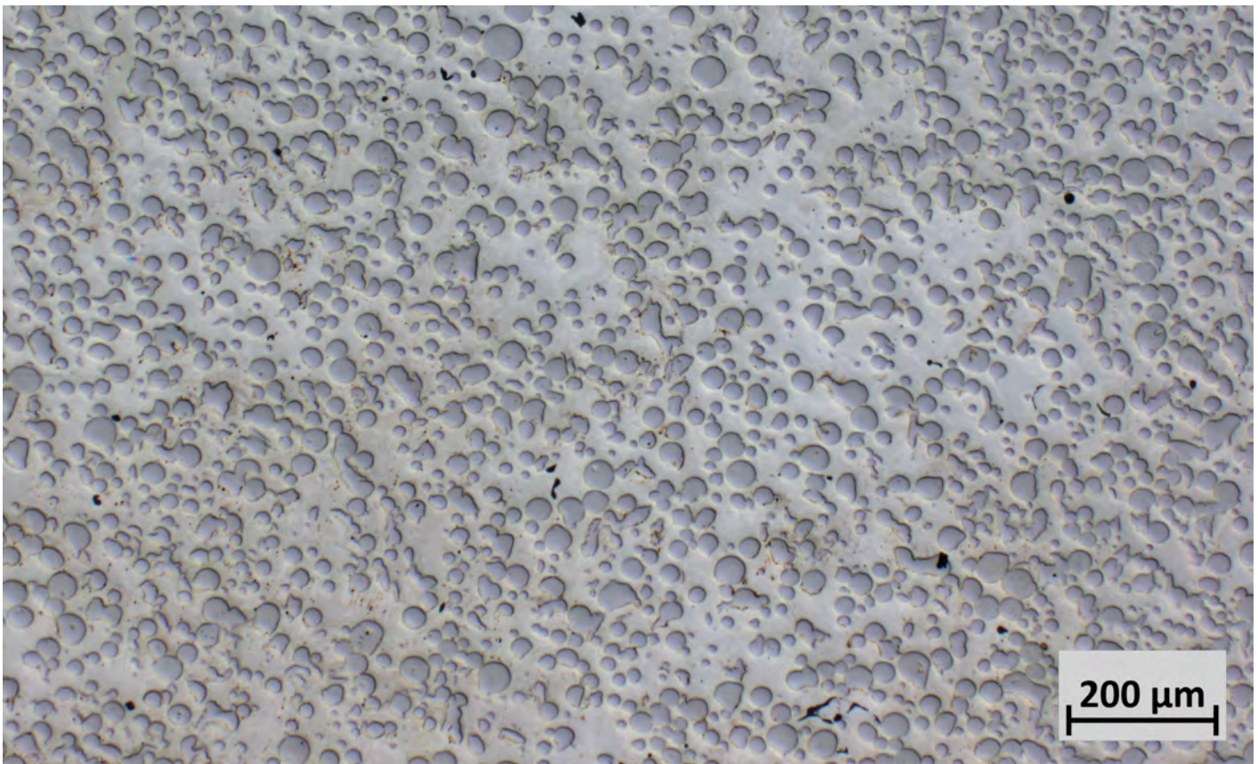
Mikrostruktur eines Stahl-Wolfram-MMCs.
